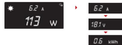
Puissance de production instantanée (W), courant de production instantané (A), tension instantanée en (V), et historique de production (kWh).
