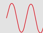
Les modèles Pur Sinus délivrent une tension parfaitement stable, de même qualité que le réseau électrique. Ils alimentent ainsi tous les appareils, même les plus sensibles (Machine à espresso, Frigo, etc...)
